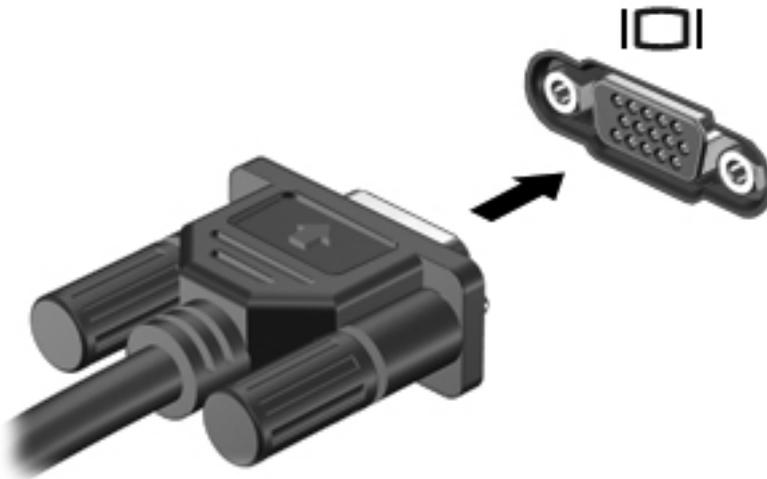
**注：** 如果正确连接的外部显示设备没有显示图像，请按 **fn+f4** 组合键以将图像传送到该设备。反复按 **fn+f4** 组合键可以在笔记本电脑显示屏和该设备之间切换屏幕图像。
