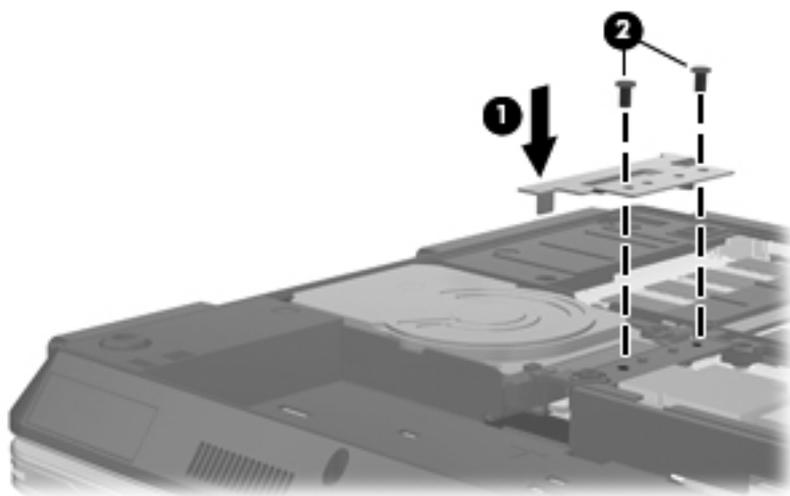
5. 将硬盘驱动器盖上的卡舌 (1) 对准笔记本电脑上的相应槽口。
